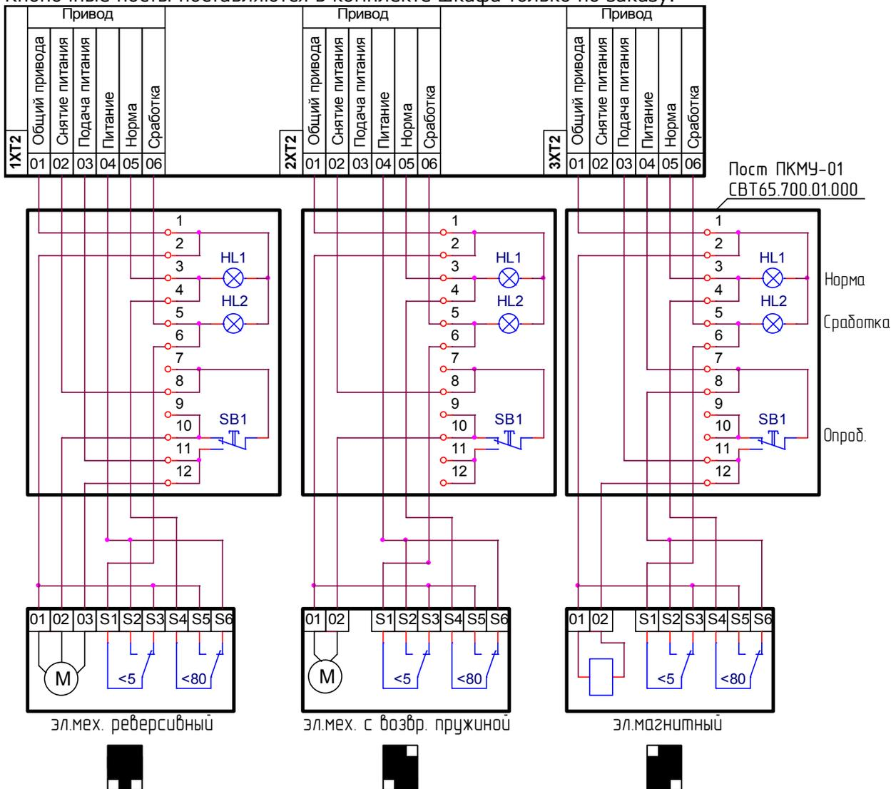
15. Индикаторы [Норма] и [Сработка] кнопочного поста включаются одновременно с соответствующими индикаторами шкафа управления и отражают текущее положение данного клапана.
