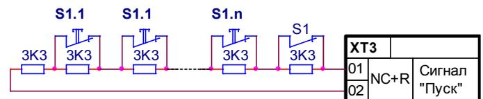
Контакты кнопок S1.1 - S1.n должны размыкаться при нажатии. Пуск происходит при нажатии любой кнопки или при размыкании управляющих контактов ППУ (также смотри **командный режим** ниже).
