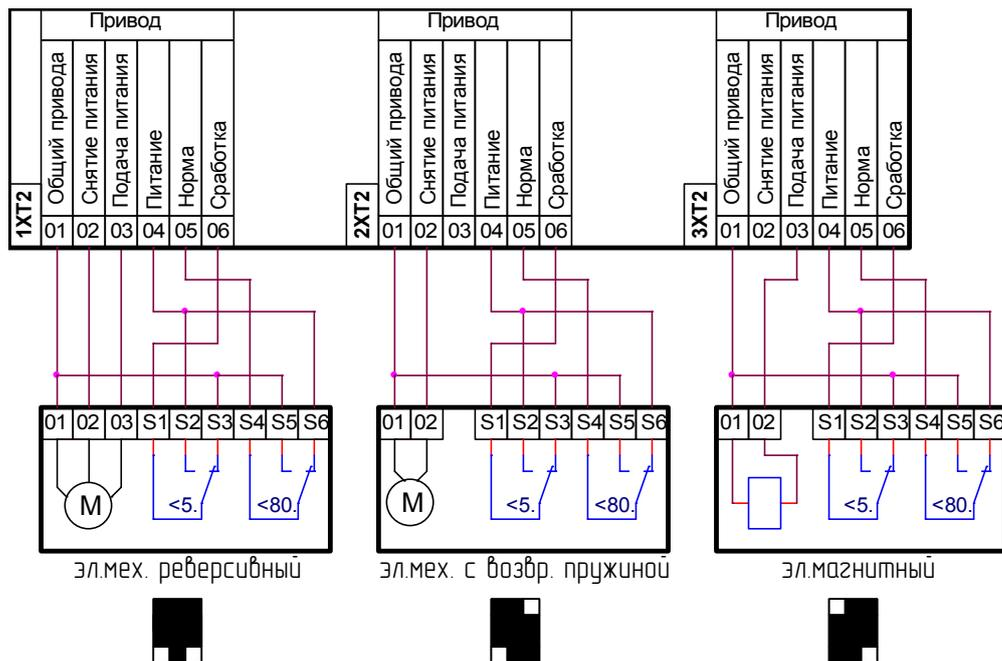
1. При подключении использовать кабель с сечением проводов не более 2,5 мм<sup>2</sup>.
